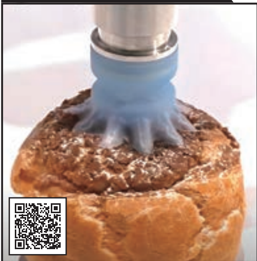
食品衛生法に対応した 吸着パッドでの食品(裸品)吸着
