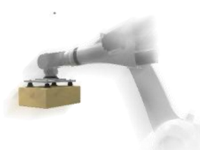
ロボットを利用した吸着搬送
