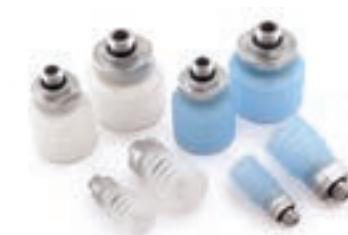
本製品は、従来の2段、3段じゃばらタイプの吸着パッドに比べクッション性がアップし、凹凸のあるワークの吸着搬送にご使用いただけます。また、ワークに応じて吸着パッドゴムの材質硬度を40度、55度の2種類から選択ができます。
