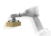
ロボットを利用した吸着搬送
