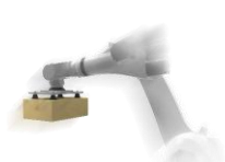
ロボットを利用した吸着搬送
