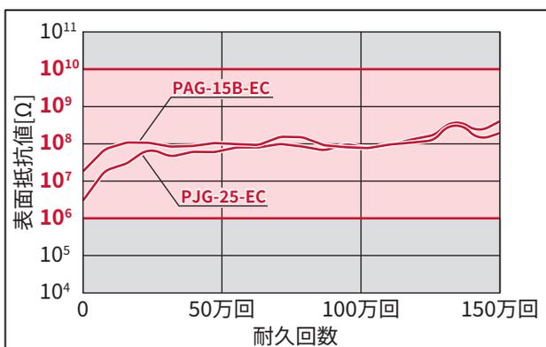
コーティングによるESD対策とは違い材料自体の配合で導電性を制御しているため表面抵抗値の変動が安定します。
