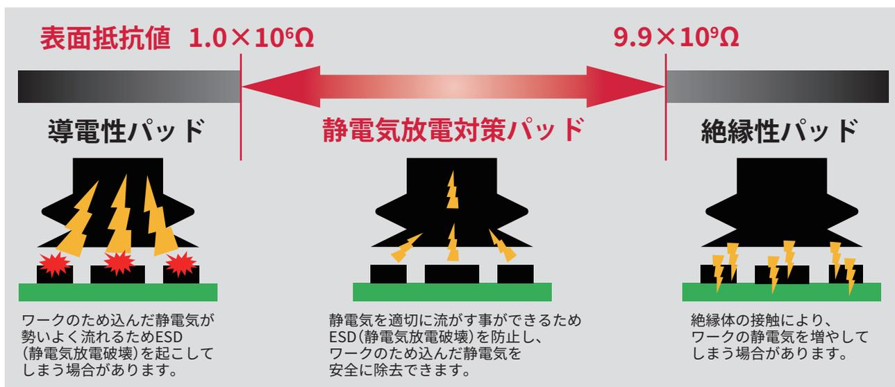
当社の表面抵抗値の測定はANSI/ESD STM11.13に基づき測定を行っております。規格では表面抵抗値 $1.0 \times 10^4 \sim 1.0 \times 10^{11} \Omega$ の範囲が静電気拡散性範囲と定められていますが、当社は規格よりも厳しい表面抵抗値 $1.0 \times 10^6 \sim 9.9 \times 10^9 \Omega$ で管理し、製品を全数検査し出荷しております。(検査成績書付属)
