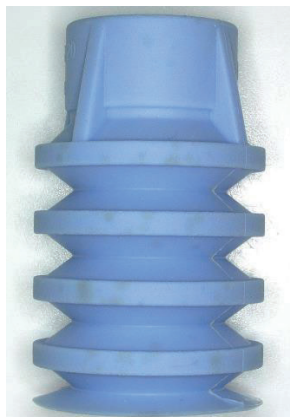
図、黒いシミが発生したパッド
